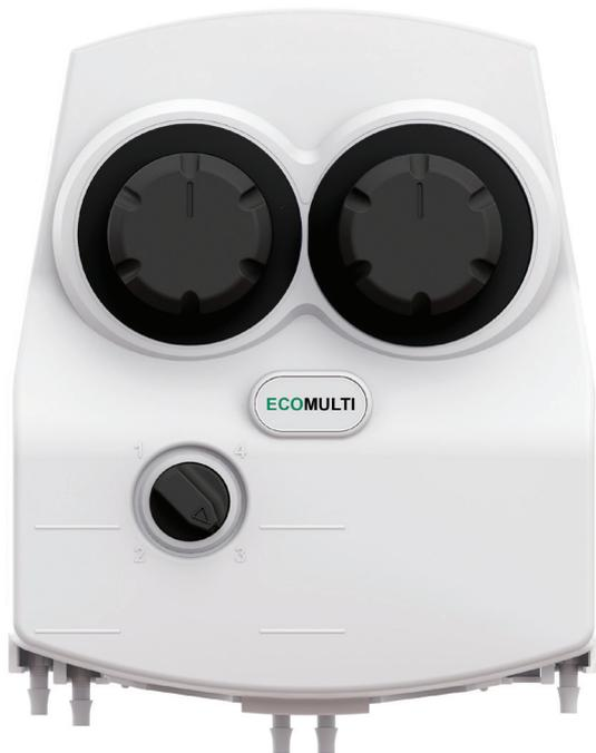
**ECOMULTI** est un système venturi qui distribue jusqu'à 5 produits chimiques dans un distributeur. Idéal pour une utilisation avec des flacons vaporisateurs, des seaux ou des autolaveuses, le système a été conçu avec deux doseurs distincts permettant d'associer des applications à haut débit (14 L/min) et faible débit (4 L/min).
